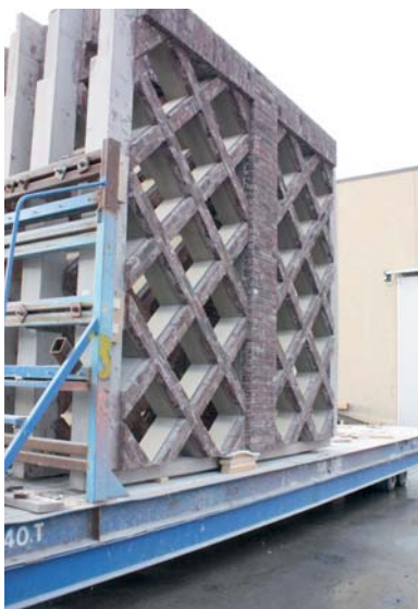
Den värdefulla råvaran anländer till betongfabriken i Herrljunga, rasterväggarna tillverkas och de färdiga betongelementen ställs upp för leverans.
